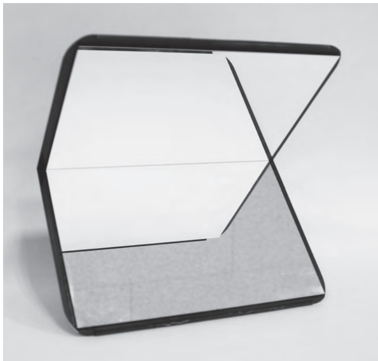
【図8】 90°回転させたリバーサルミラー
